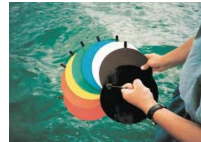
Zur einfachen Bestimmung des Lichtklimas im Wasser werden diese farbigen Sichttiefen-Scheiben benutzt.
