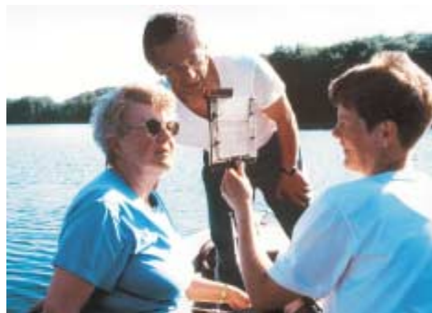
Mit dem selbst erdachten und gebauten Sauerstoff-Kolorimeter der BONITO-Mitarbeiter Richter und Päsler wurde die umfangreiche und häufige Verprobung der Feldberger Gewässer im Hinblick auf den molekular im Wasser gelösten Sauerstoff möglich. Das Gerät gelangte seinerzeit in der DDR nicht zur seriellen Herstellung, aber BONITO baute und lieferte es zigfach in das östliche und westliche Ausland.
