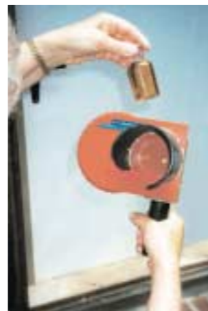
Die Grobbestimmung von Plankton erfolgt mit einer selbst erdachten bzw. erprobten Kuvette unmittelbar nach dem Fang.
