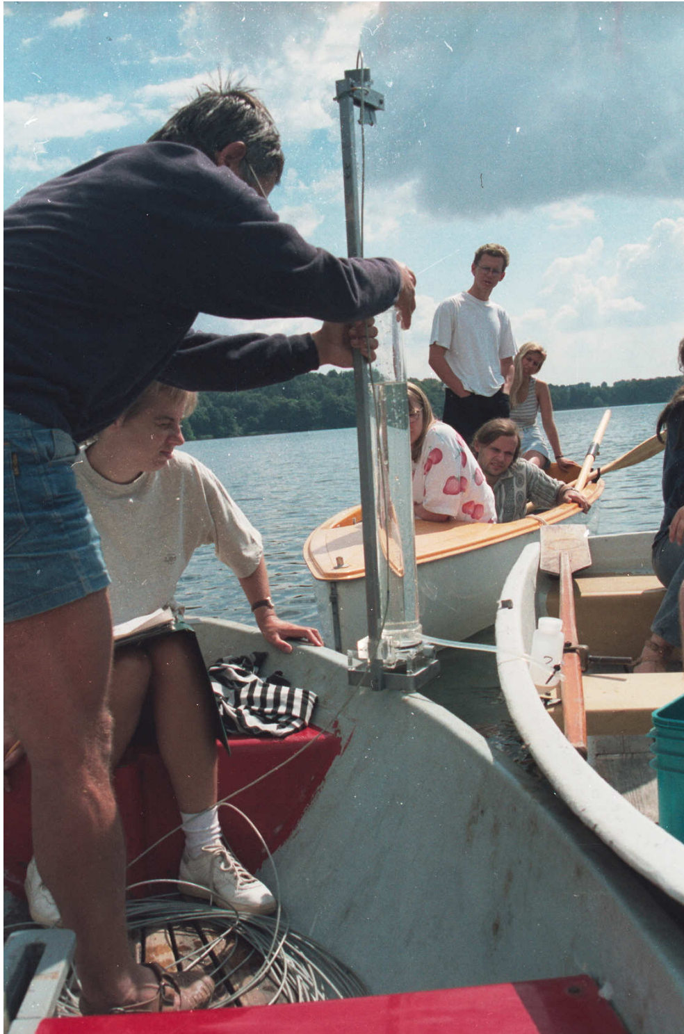
Abb. 4 : Einfaches Arbeiten durch Absenken des Kabels mit der Sauerstoffsonde (links) und selbstgebautes, modifizierten Kunststoff-Ruttnerschöpfer zur Probenentnahme aus unterschiedlichen Tiefen (rechts).
